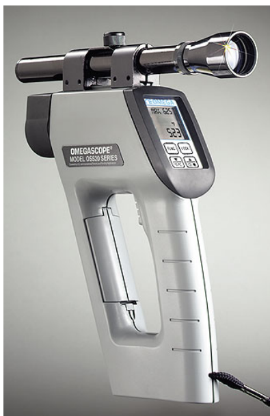
شکل (2-40): یک نمونه پیرومتر تشعشی عملی
