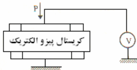
شکل (2-54): اندازه‌گیر فشار با عناصر پیزوالکتریک
