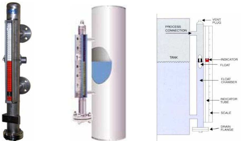
شکل (2-77): اندازه گیر لول از نوع شناوری
