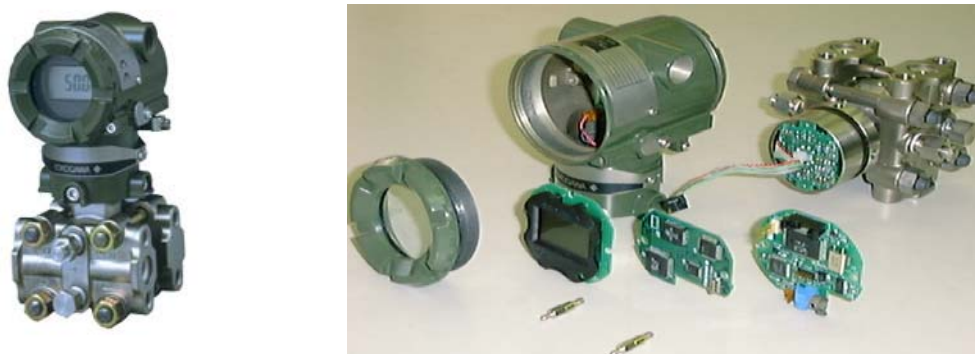
شکل (2-47): اجزاء مختلف ترانسمیتر فشار
