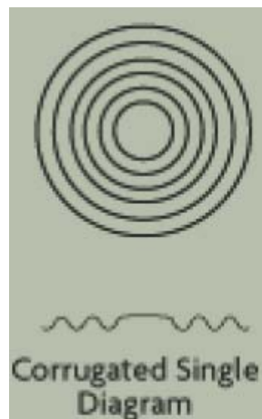
شکل (2-44): دیافراگم و ترانس‌میتور از نوع دیافراگمی
