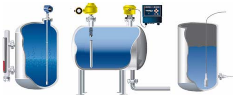
شکل (2-79): محل نصب اندازه گیر لول از نوع شناوری
