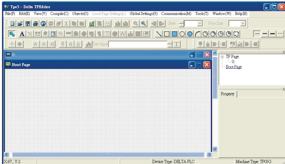
گام ۲. در صفحه Boot Page، تنها دو شیء می توانید ایجاد نمایید: Static Text و یا Static Bitmap. برای ایجاد کادر Static Text، یا بر روی آیکون در نوار ابزار کلیک کنید و یا از مسیر زیر را انتخاب نمایید. (Objects(O)>Static Text(T)). بعد از این کار، نمایشگر ماوس بصورت یک "+" در خواهد آمد. برای ایجاد کادر، کلید سمت چپ ماوس را پایین نگه داشته و کادر دلخواه خود را ایجاد نمایید. برای بازگشت
