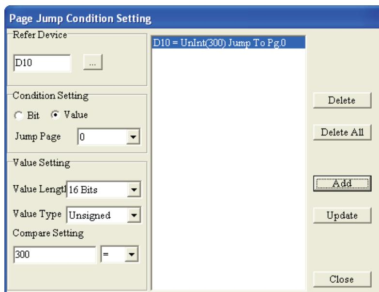
گام ۴. در صورتیکه می خواهید شرط پرش را برای یکی از رجیسترهای D و یا یکی از کانترهای C از داخل PLC تعریف نمایید، در کادر Refer Device Name مربع کنار Device Name را تیک زده و D یا C یا T را انتخاب نمایید. در کادر Device Number شماره آن را وارد کنید. آدرس PLC را در کادر Set PLC ID و پورتی را که از طریق آن دستگاه نمایشگر با PLC ارتباط دارد، در قسمت TP Port وارد نمایید.
