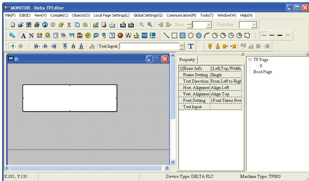
گام ۳. بر روی کادر ایجاد شده دوبل کلیک کنید. پنجره ای باز می شود که می توانید تنظیمات مربوط به Static Text را در آن انجام دهید.
