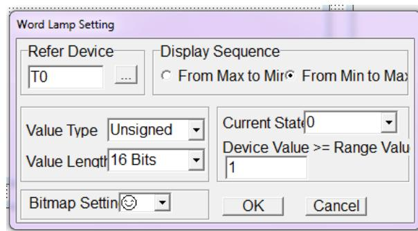
بر روی نوار Device Value $\geq$ Range Value دبل کلیک کنید و دو مقدار ۱ و ۸۰ را بصورت زیر وارد نمایید :
