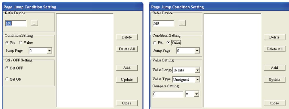
گام ۳. در صورتیکه می‌خواهید شرط پرش را برای یکی از کناتکتهای PLC X,Y,M,S,T,C از داخل PLC تعریف نمایید، در کادر Refer Device Name مربع کنار Device Name را تیک زده و یکی از آنها را انتخاب نمایید. در کادر Set PLC ID PLC شماره آن را وارد کنید. آدرس PLC را در کادر Device Number و پورتی را که از طریق آن دستگاه نمایشگر با PLC ارتباط دارد، در قسمت TP Port وارد نمایید.
