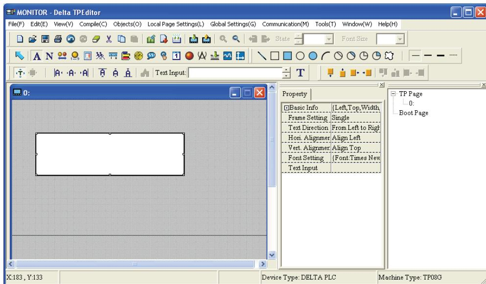
گام ۲. بر روی کادر ایجاد شده دوبل کلیک کنید. پنجره‌ای باز می‌شود که می‌توانید تنظیمات مربوط به Static Text را در آن انجام دهید.
