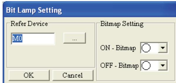
از شیء Bit Lamp برای نمایش وضعیت ON و یا OFF بودن رله ها و کنتاکتها بصورت شکلک استفاده نمایید. در صورتیکه می خواهید اطلاعات یکی از کنتاکتهای X,Y,M,S,T,C را از داخل PLC بخوانید، در کادر Device Name مربع کنار Set PLC ID را تیک زده و یکی از آنها را انتخاب نمایید. در کادر Device Number شماره آن را وارد کنید. آدرس PLC را در کادر ویورتی را که از طریق آن دستگاه نمایشگر با PLC ارتباط دارد، در قسمت TP Port وارد نمایید.
