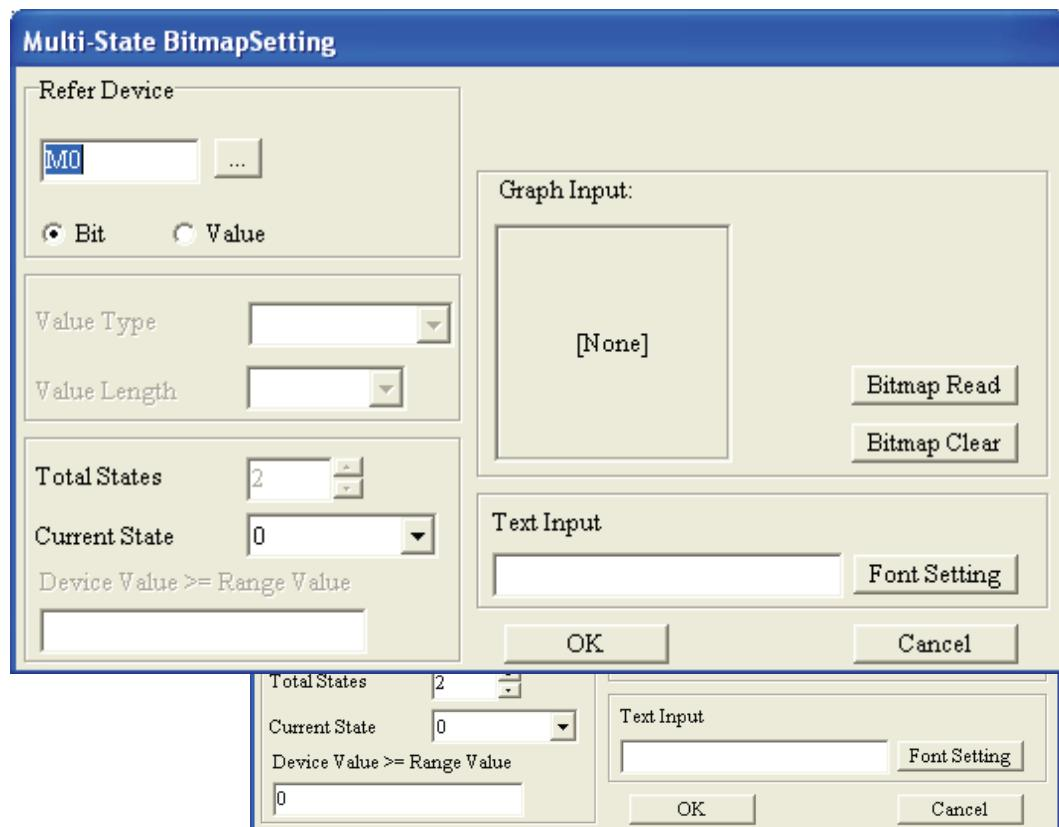
گام ۲. اگر در قسمت "From Min to Max" ، Refer Device را انتخاب نمودید ، توالی صعودی "Value" و یا نزولی "Display sequence" را از قسمت "From Max to Min" انتخاب نمایید .
