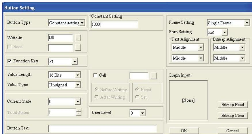
**VI** : هنگامی که این کلید فشرده می شود، ابتدا مقدار رجیستری از PLC که در قسمت Write-in وارد نموده اید، توسط دستگاه نمایشگر TP خوانده می شود. سپس متناسب با تنظیمات کاربر، مقداری به آن اضافه و یا از آن کم شده و مقدار جدید در همان رجیستر ذخیره می شود. مقدار افزایش و یا کاهش برای هر بار فشرده شدن کلیدرا، در قسمت Jog Setting وارد نمایید. در قسمت Range Limit، مقدار ماکزیمم را در حالت Increase Button و مقدار مینیمم را در حالت Decrease Button وارد نمایید.
