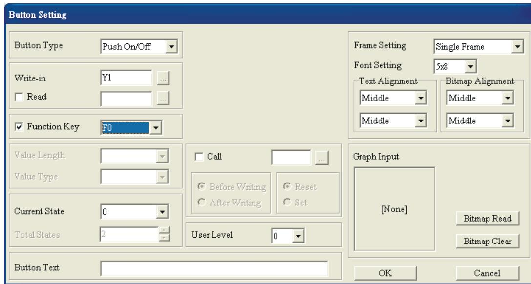
از قسمت Write-in نوع Push ON/OFF را انتخاب نمایید. در قسمت Write-in آیکون کلیک نمایید. در پنجره گشوده شده، Y1 را انتخاب نمایید. انتخاب Y1 بدين معناست که دستگاه نمایشگر TP می تواند کن tact Y1 از PLC را کنترل نماید. تنظیم آدرس PLC خیلی مهم است. در قسمت Set PLC ID آدرس PLC اول را وارد نمایید.
