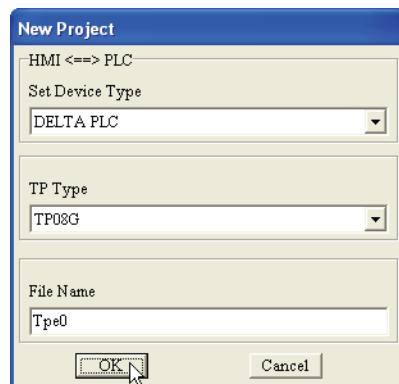
گام ۳. با کلیک بر روی علامت □ در کنار هریک از نوارهای سفید، در نوار بالای نوع دستگاه مرتبط با دستگاه نمایشگر TP، در نوار وسطی نوع دستگاه نمایشگر TP و در نوار پایینی، نام فایل را انتخاب نمایید.
