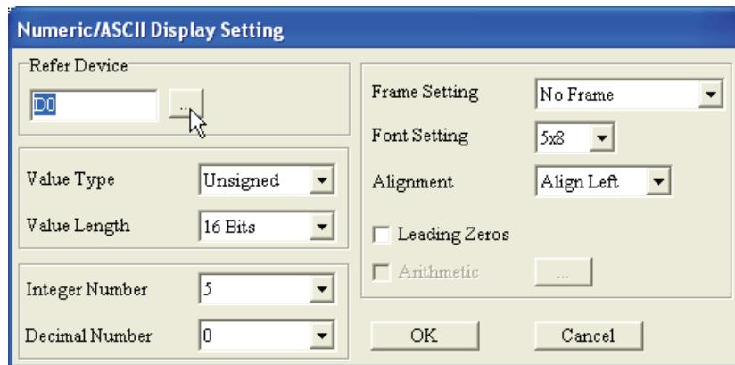
گام ۲. برای مشخص نمودن دستگاه مرتبط با نمایشگر، بر روی آیکون [...] در این پنجره کلیک نمایید.
